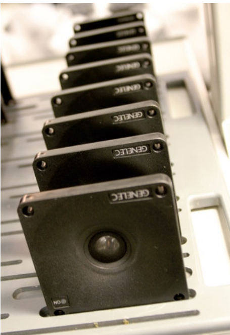
O tweeter de alumínio anodizado da Genelec em produção
