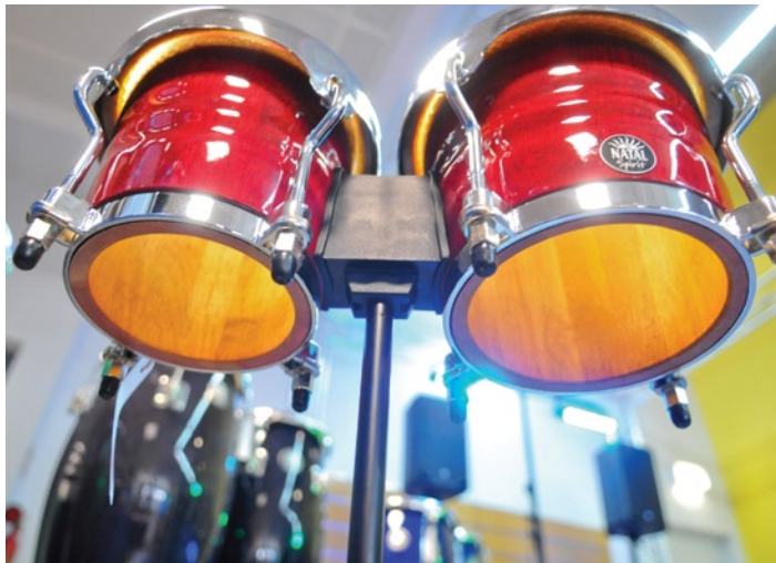
Pormenor de sistema que permite enroskar uns bongós a um suporte de microfones, simples e de enorme versatilidade na estrada
